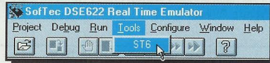
Fig.135 Per correggere in maniera definitiva il programma BTEST è necessario apportare le correzioni nel sorgente, cioè nel file BTEST.ASM . Dal DSE è possibile accedere direttamente all'editor dell' ST6 , scegliendo ST6 dal menu Tools .
