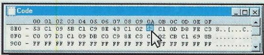
Fig.132 Nella finestra Code viene evidenziato 5B , che è il valore esadecimale corrispondente all'istruzione set 2 . Cliccate due volte su questo valore, per aprire la finestra di dialogo visibile in fig.133.
