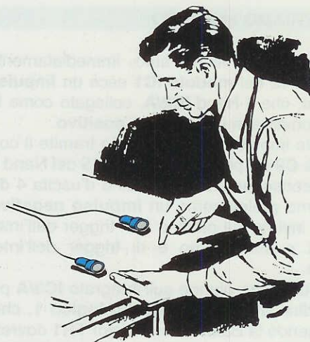
Fig.7 Ancora prima di applicare l'antifurto nell'auto, lo potrete collaudare al banco passando di fronte alle due capsule ultrasoniche poste sul piano di un tavolo.
