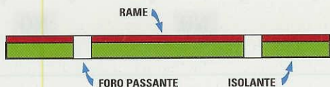
Fig.151 Vengono chiamati circuiti stampati MONOFACCIA quelli che hanno le piste in rame poste da un solo lato della basetta isolante utilizzata come supporto. I circuiti stampati professionali utilizzano come supporto isolante la vetronite.
