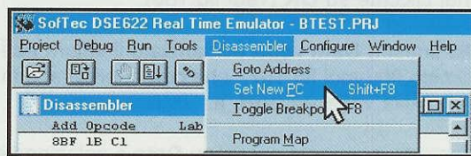
Fig.111 Il sottomenu Set New PC vi consente di aprire la finestra di dialogo New program counter (vedi fig.112).
