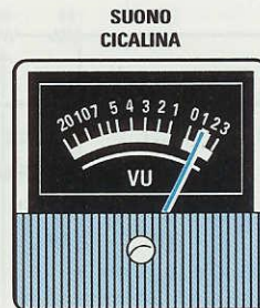
Fig.6 In presenza di un metallo la lancetta dello strumento devierà verso il fondo scala e subito udrete la cicalina emettere una nota acustica.
