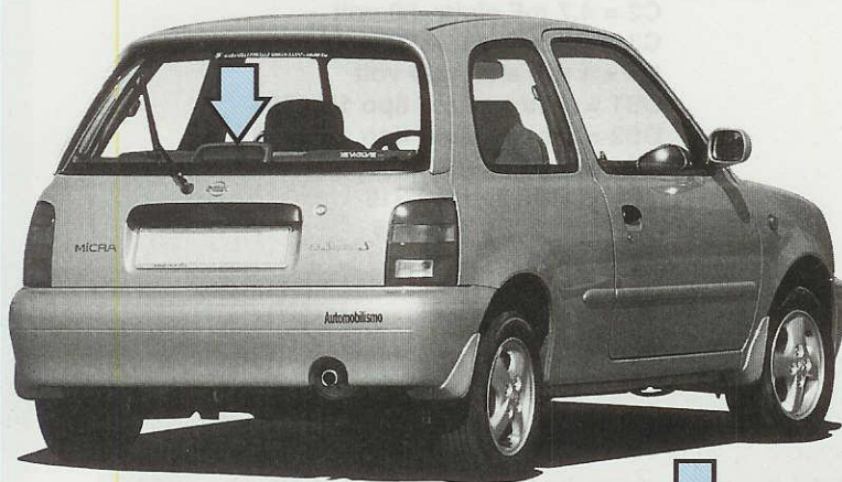
Fig.1 Tutte le nuove auto sono dotate di un Light Stop perché si presume che ben presto diventi un accessorio obbligatorio.
