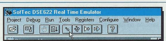
Fig.100 Ogni volta che si clicca sull'icona passo-passo viene eseguita una sola istruzione del programma.
